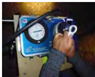
Chambre à pression de Schöllander pour mesurer le potentiel hydrique foliaire.
