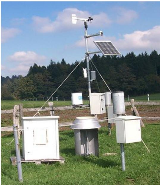
L'ETP, calculée à partir de mesures météorologiques (rayonnement, température, humidité, vent), correspond à l'évapotranspiration d'un couvert de raygrass italien au stade épiaison.
