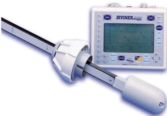
**Les sondes capacitatives** comptent par électromagnétisme les molécules d'eau présentes dans un volume de sol défini autour du capteur. Ce capteur est plongé dans un tube en PVC installé une fois pour toutes dans le sol étudié. Il mesure alors, par tranche de 10cm de sol, une fréquence qui correspond à la quantité de molécules d'eau présentes.
