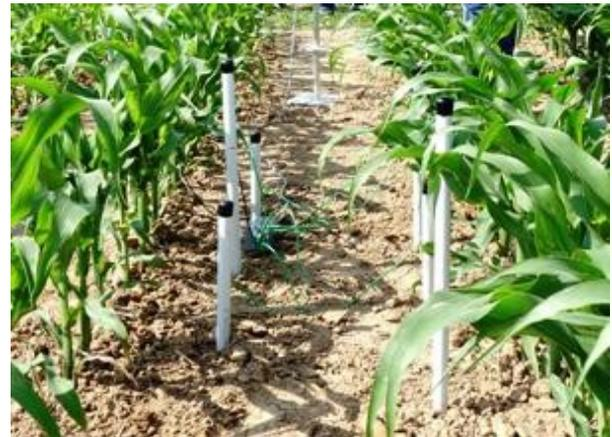
En aspersion, on déclenche la première irrigation lorsque les tensiomètres placés à 30 cm de profondeur décrochent ou arrivent à 70-80cb. Les irrigations suivantes sont réalisées lorsque les tensiomètres placés à 60 cm de profondeur atteignent la valeur qu'ils avaient atteint au moment du décrochage des tensiomètres à 30cm.
