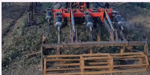
Légende : Intercep mécanique monté sur cadre de labour
