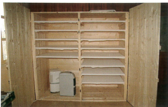
Exemple de séchoir armoire avec déshumidificateur dans l'enceinte de séchage - Crédit photo : Thibaut Joliet
